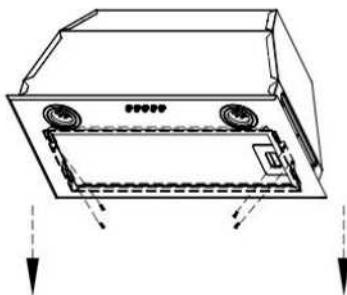
2. Надежно закрепите корпус вытяжки к шкафчику 12 винтами.
