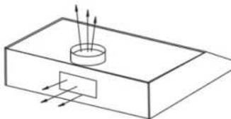
**Рециркуляция:** Для функционирования вытяжки в режиме рециркуляции подсоедините угольный фильтр. Поверните переключатель в режим рециркуляции. В этом режиме воздух будет проходить через угольный фильтр, а очищенный воздух будет проходить через отверстия в передней части корпуса вытяжки.
