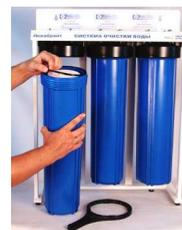
5. Уплотнительное кольцо (прокладку) смажьте силиконовой смазкой из пакетика (в комплекте) и поместите в паз корпуса фильтра.
