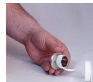
5. Намотайте фум-ленту или сантехнический лён, на резьбу входящей трубы или фитинг трубы и прикрутите к крышке фильтра первой ступени (ВНИМАНИЕ !!! избыток намотки и/или усилия при закручивании, может привести к поломке корпуса фильтра).
