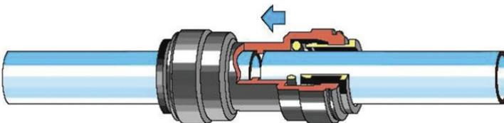
Потяните трубку от фитинга для проверки надёжности соединения. Следует это взять за правило для проверки системы после замены картриджей перед тем, как подать давление.
