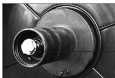
Используйте гаечный ключ для поворота винта регулятора тормозного усилия (1) согласно схеме на Рисунке. При настройке подходящего тормозного усилия убедитесь, что проволока не слишком свободно намотана на катушку и ложится ровно. Если установить слишком высокое значение тормозного усилия, то это увеличит нагрузку подачи проволоки. Как правило, чем быстрее подача проволоки, тем больше тормозное усилие.
