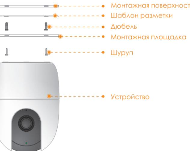
**Шаг 1** Просверлите отверстия для винтов на монтажной пластине согласно схеме монтажа и вставьте дюбели.
