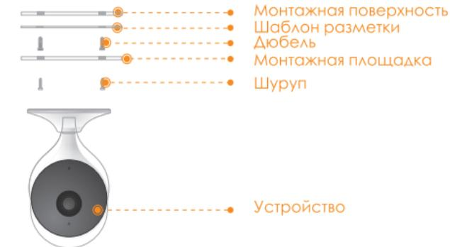
**Шаг 1** Просверлите отверстия для винтов на монтажной пластине согласно схеме монтажа и вставьте дюбели.
