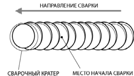
Рис. 9.4. Начало сварки при смене электрода.
