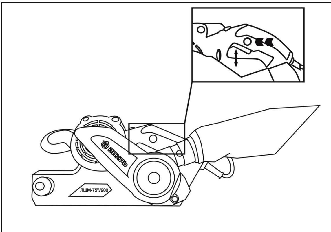
Рис.5 Клавиша выключателя
