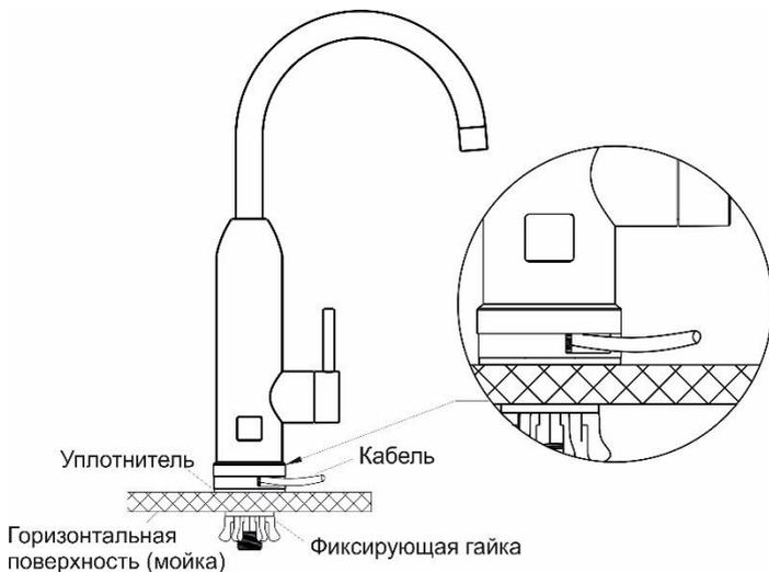
Рис. 2. Установка с выводом кабеля питания над мойкой
