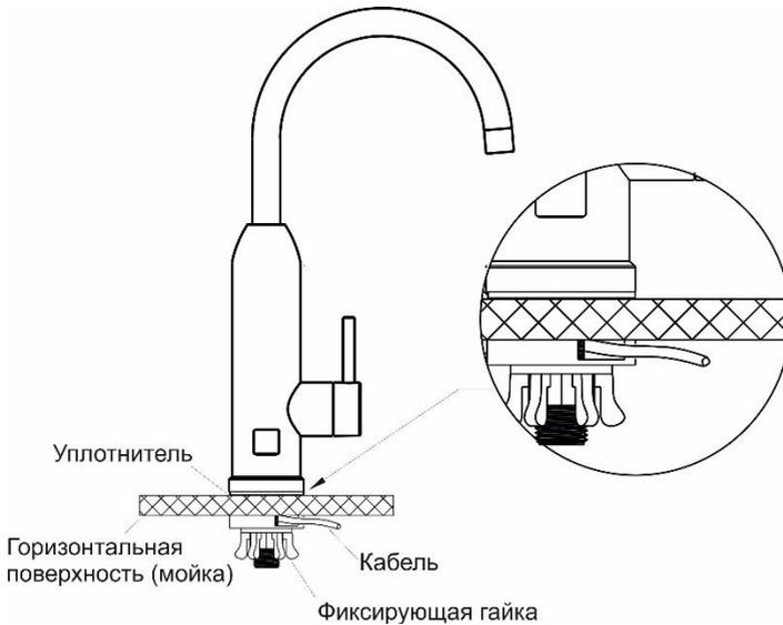
Рис. 3. Установка с выводом кабеля питания под мойкой
