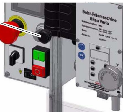
Рис. 1-3: Отключающее защитное оборудование
