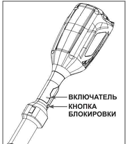
Рис. 9 Расположение органов управления на задней рукоятке
