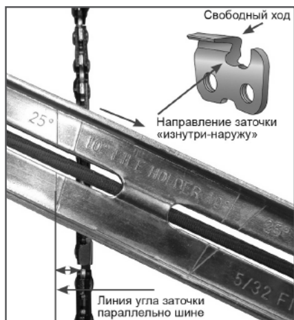
Рис. 18 Определение угла заточки
