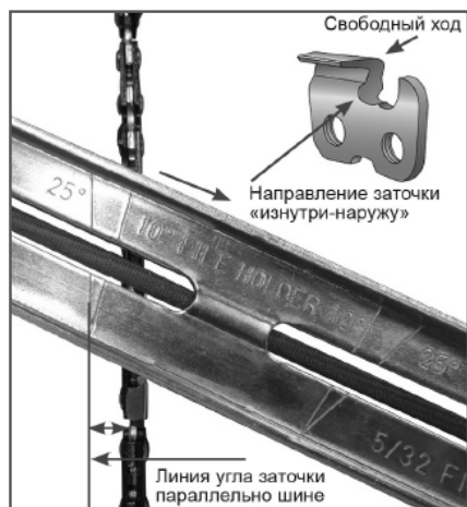
Рис. 14. Определение угла заточки
