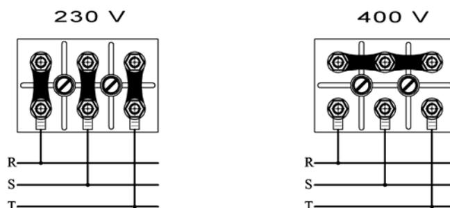
**IMPORTANTE:** Desconectar la máquina de la red antes de proceder a cambiar la posición de las plaquitas puente en los motores, también deberá proceder a cambiar las etiquetas adhesivas indicativas del voltaje de alimentación, de esta forma quedará siempre indicado el voltaje establecido en la máquina.
