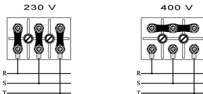
**WAŻNE:** Przed przystąpieniem do zamiany miejsca blaszek na mostku silnika, należy odłączyć maszynę od prądu. Trzeba również zastąpić samoprzylepne etykiety informujące o nowym napięciu zasilania nowymi, aby w ten sposób był zawsze pokazany woltaż, przy którym pracuje maszyna.
