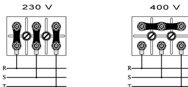
**IMPORTANTE:** Sconnettere la macchina dalla rete elettrica prima di procedere al cambio di posizione delle placchette-ponte dei motori, inoltre si dovra' procedere a cambiare le etichette adesive che indicanti il voltaggio d'alimentazione, in questo modo il voltaggio sara' sempre quello stabilito nella macchina.
