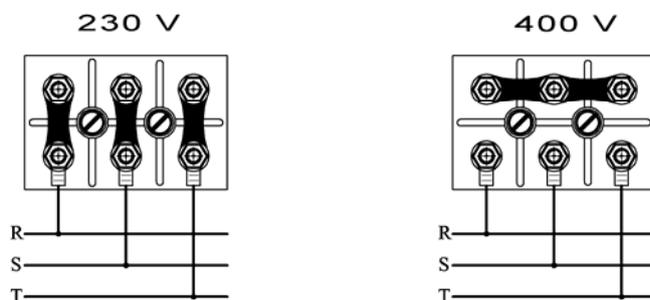
**ВАЖНО:** Всякий раз, меняя положение контактов в двигателе, непременно смените стикер с обозначением настроенного напряжения.
