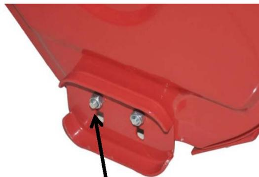
Болты крепления башмаков кожуха шнека
