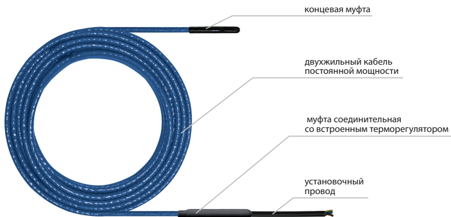
Рис. 1. Конструкция нагревательной секции
