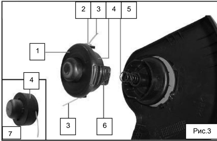
В результате обычного использования функции выдвигания лески со временем заканчивается режущая леска или наступает износ катушки, поэтому катушку требуется периодически менять и вставлять новую леску. Режущую леску и сменные катушки можно приобрести в сети розничной торговли.
