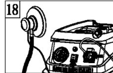
После завершения работы электроинструмента, пылесос выключится автоматически через небольшой промежуток времени.
