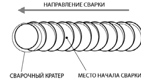
Рис. 11.6. Начало сварки при смене электрода.
