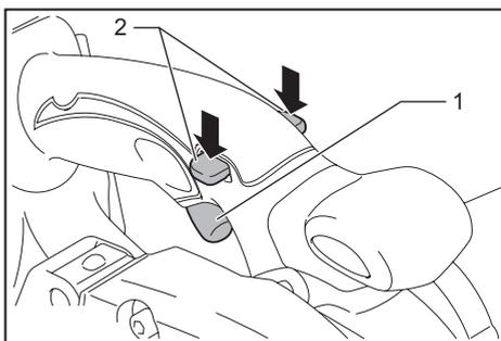
► 1. Триггерный переключатель 2. Рычаг блокировки в выключенном положении
