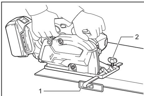
▶ 1. Направляющая планка (направляющая линейка) 2. Зажимной винт
