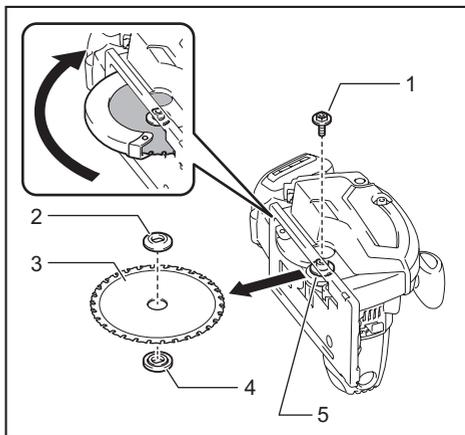
► 1. Болт с шестигранной головкой 2. Наружный фланец 3. Диск циркулярной пилы 4. Внутренний фланец 5. Колпачковая шайба
