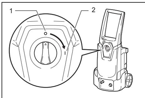
► 1. Положение OFF (Выкл.) 2. Положение ON (Вкл.)
