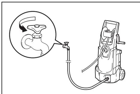
**ПРИМЕЧАНИЕ:** Чтобы защитить механизм водоструйного аппарата высокого давления, используйте воду температурой не более 40°C.
