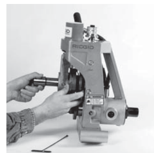
Рисунок 18 – Снятие удерживающего вала и накаточного ролика
