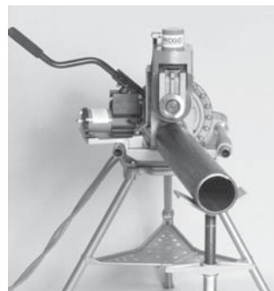
Рисунок 12 – Смещение трубы на 918 в положении FORWARD
