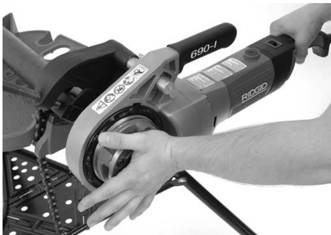
Figura 13 – Inicio del roscado
