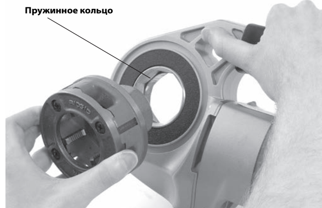
Рис. 9 – Установка резьбонарезных головок в силовой привод 600-I
