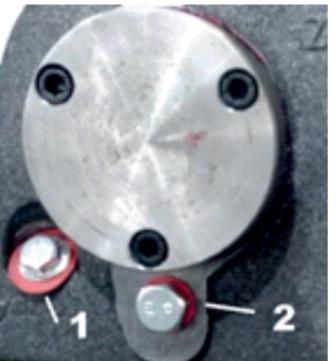
*Рисунок 3 – Маслозаливная и сливная пробки*
