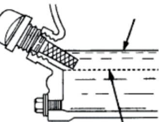
*Рисунок 2 - Проверка уровня масла в двигателе*
