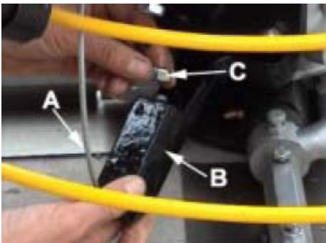
ЭТАП 2. При установленной на нижний блок ручке подсоедините контрольный кабель (А) через кронштейн (В), используя остающуюся 10 мм гайку (С). Затяните гайку.
