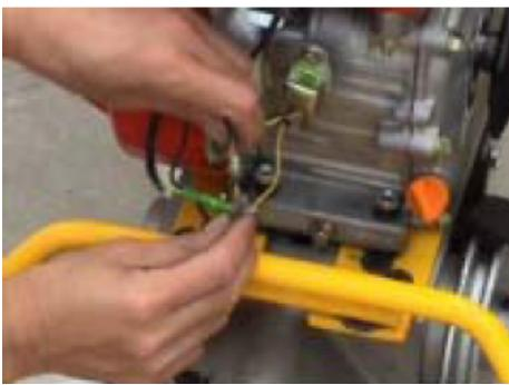
ЭТАП 3. Присоедините провод остановки к двигателю, используя соединитель проводов, поставляемый с нижним блоком.
