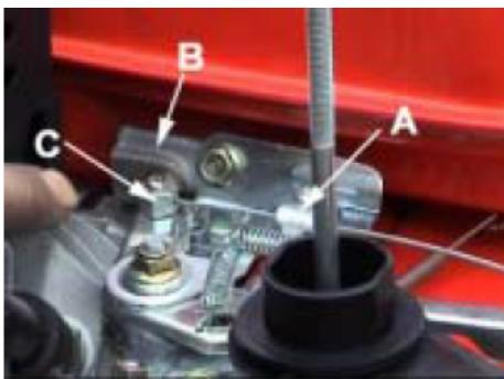
ЭТАП 4. Убедитесь, что рычаг управления двигателем на блоке ручки полностью передвинут вперед. Снимите с двигателя крышку сапуна и сапун с двигателя. Открутите регулировочный фиксатор кабеля (А). Далее убедитесь, что рычаг управления двигателем (В) на двигателе полностью передвинут вперед. Вставьте окончание кабеля в отверстие (С), как показано на рисунке. Когда все будет установлено на место, установите обратно регулировочный фиксатор кабеля (А) и затяните крепления.
