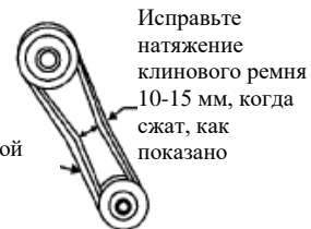
Рисунок 2. Натяжение клинового ремня
