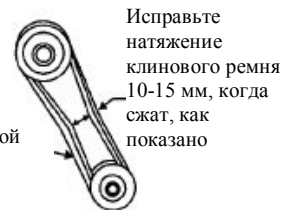
Рисунок 2. Натяжение клинового ремня
