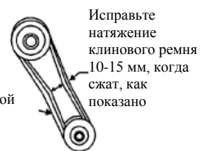
Рисунок 2. Натяжение клинового ремня
