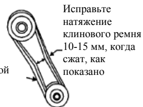
Рисунок 2. Натяжение клинового ремня
