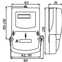
Рисунок А.2 — Тип корпуса ШЗ3
