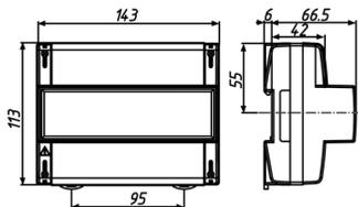
Рисунок А.3 — Тип корпуса P31
