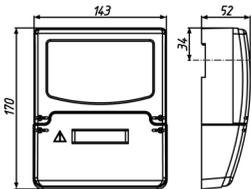
Рисунок А.1 — Тип корпуса P32
