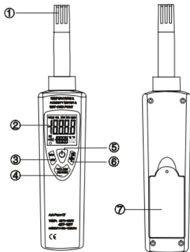
1. Зонд влажности/температуры воздуха: внутри находится полупроводниковый датчик влажности и температуры.
