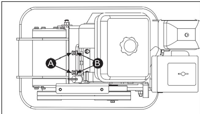
2. Ослабьте зажимные гайки В, оставляя достаточно пространства между гайкой и скобой.
