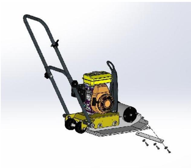
Закрепите коврик на виброплите, как показано на рисунке. Совместите отверстия в виброплите, коврике и прижимных пластинах. Закрепите коврик с помощью стопорных шайб 10 и болтов M10x30.
