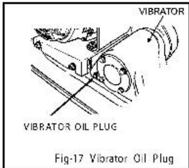
5. Стоя от виброплиты справа по ходу движения снимите заглушку слева внизу с торцевой части вибратора. Переверните плиту, чтобы масло вытекло. Проверьте масло на предмет наличия металлической стружки для предотвращения проблем в будущем.
