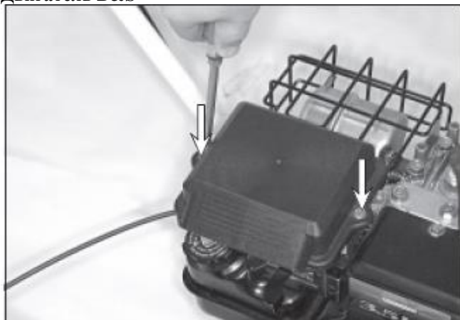
1) Ослабить болт крышки воздушного фильтра с помощью комбинированного ключа.
