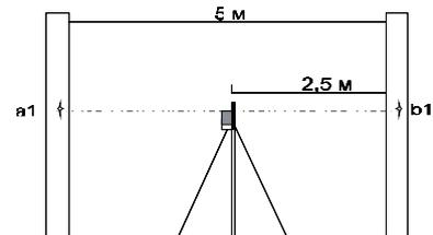
Пример: При проведении проверки лазерного построителя плоскостей, разница: {a1-a2} = 5 мм и {b1-b2} = 7 мм. Таким образом полученная погрешность прибора: {b1 -b2}-{a1-a2} = 7-5 = 2 мм. Теперь Вы можете сравнить полученную погрешность, с величиной погрешности, заданной производителем. Если точность лазерного построителя не соответствует заявленной, необходимо обратиться в авторизованный сервисный центр.
