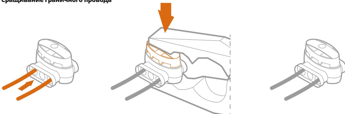
В комплектацию Landroid входят два небольших водонепроницаемых соединителя граничного провода. Их можно использовать для следующих целей:
