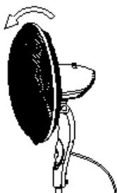
Конструкция прибора позволяет изменять направление воздушного потока, регулируя угол наклона вентилятора. Для этого установите необходимый угол наклона вентилятора
