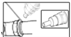
Для точечной сварки наденьте конусную насадку, для пайки труб – насадку с отражателем.
