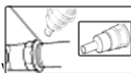
Для точечной сварки наденьте конусную насадку, для пайки труб – насадку с отражателем.
