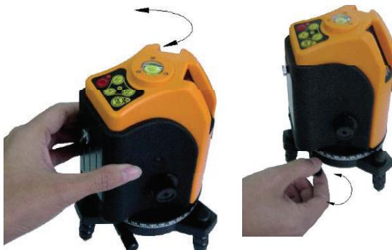
При установки прибора в вертикальном положении работает система самовыравнивания в пределах диапазона, указанного в технических характеристиках.
