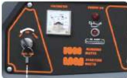
(c) Установить выключатель двигателя в положение OFF (ОТКЛ).
