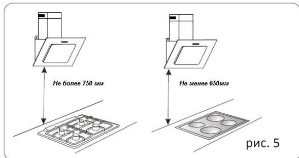
Как уже говорилось в разделе «ТРЕБОВАНИЯ ПО ТЕХНИКЕ БЕЗОПАСНОСТИ», вытяжка должна быть установлена на расстоянии 65 см - 75 см над варочной поверхностью (см. рис.5).
