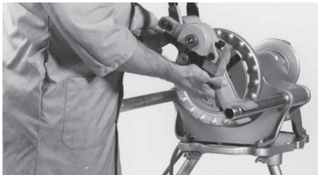
Рисунок 2 – Установка на силовой привод № 300
