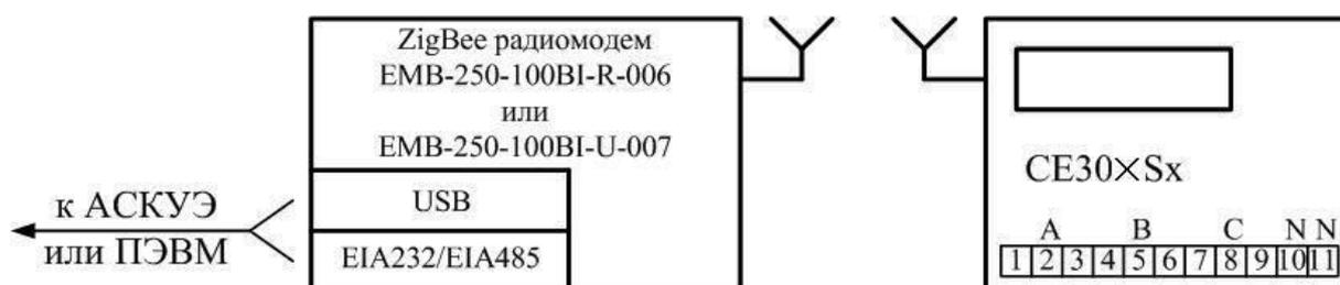
Рисунок 5.11 – Схема подключения счетчика
