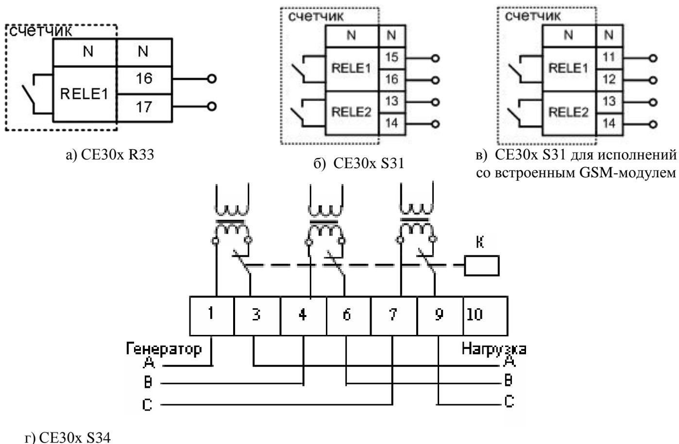
Рисунок 5.5 – Схемы подключения реле
