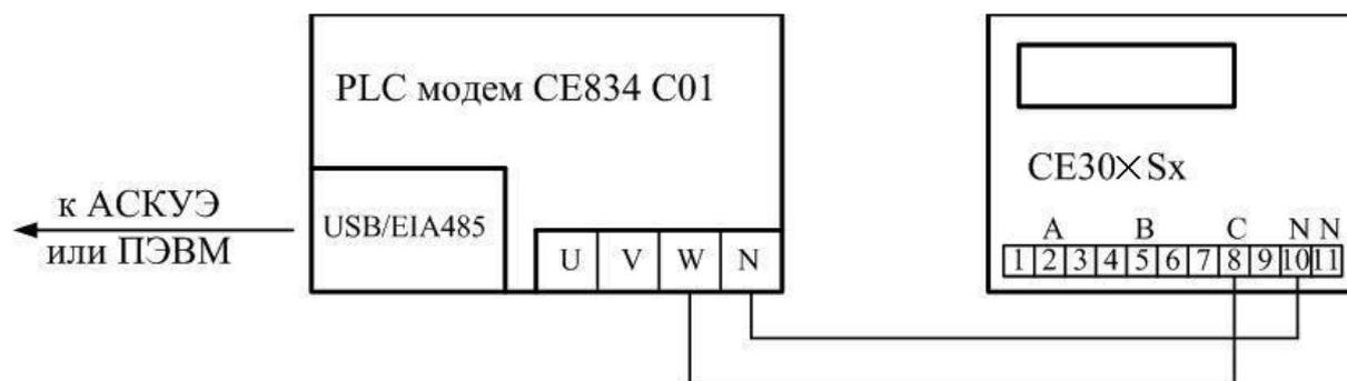
Рисунок 5.13 – Схема подключения счетчика
