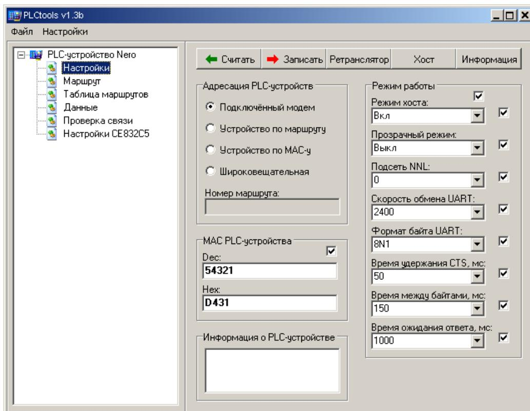
Рисунок 5.23 – Настройки PLC-модема
