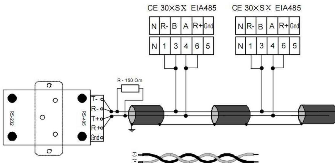
Рисунок 5.8 – Схема подключения счетчика CE30x SX с интерфейсом EIA485 через внешний адаптер EIA485/EIA232 к COM-порту ПЭВМ
