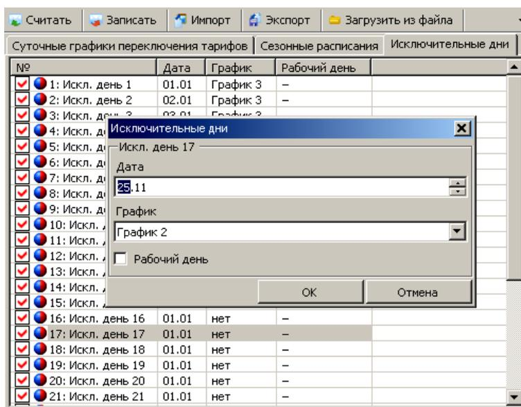
Рисунок 7.15 – Редактирование параметра таблицы «*Исключительные дни*»
