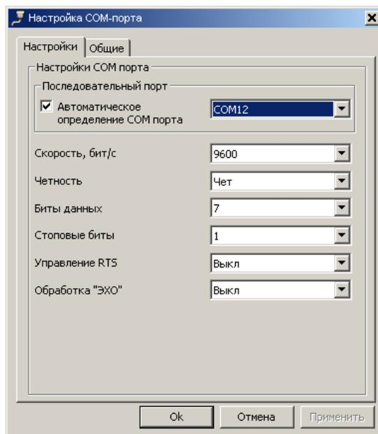
Рисунок 6.12 - Окно редактирования настроек канала связи «RS232 (CE901)»
