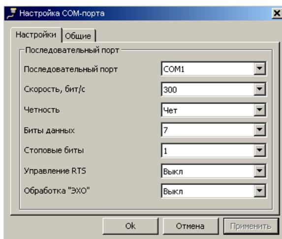
Рисунок 6.4 – Окно редактирования настроек канала связи «RS-232»
