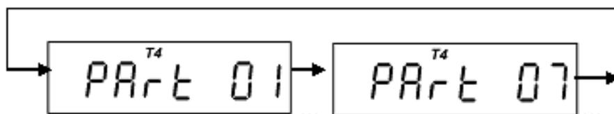
Рисунок 5.15 – Переключение между группами параметров счетчика
