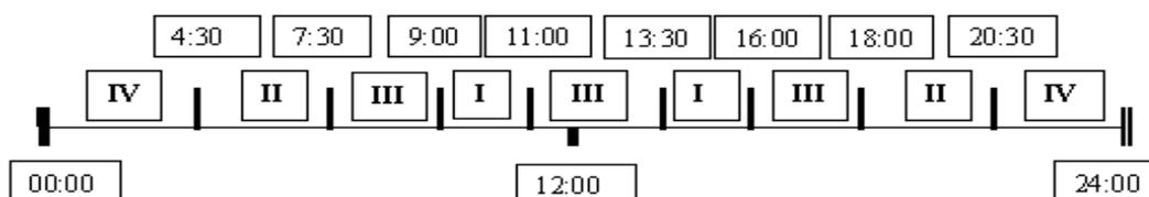
Рисунок 7.8 - Пример построения суточного расписания переключения тарифов
