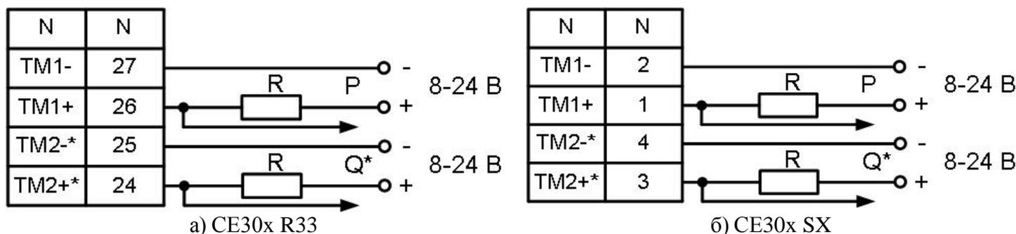
Рисунок 5.4 – Схема подключения импульсных выходов счетчика
