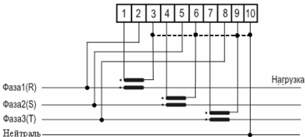
а) Схема включения счетчика СЕ30х 230 В 5(10) А
