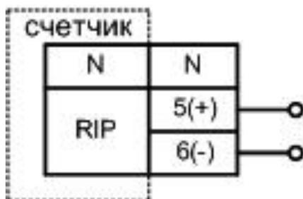
$U_{пит}=9-24$  В,  $I_{пит}=800-300$  мА (в зависимости от  $U_{пит}$ ) – для исполнений счетчика со встроенным GSM или Ethernet-модулями.
