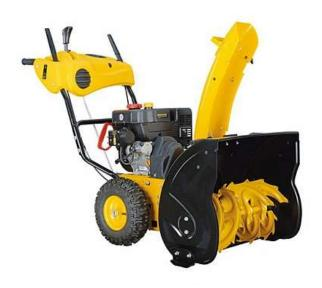
Снегоуборщик ST6706 оборудован четырехтактным одноцилиндровым бензиновым двигателем Zongshen ZS177F, объемом 270 см3.
