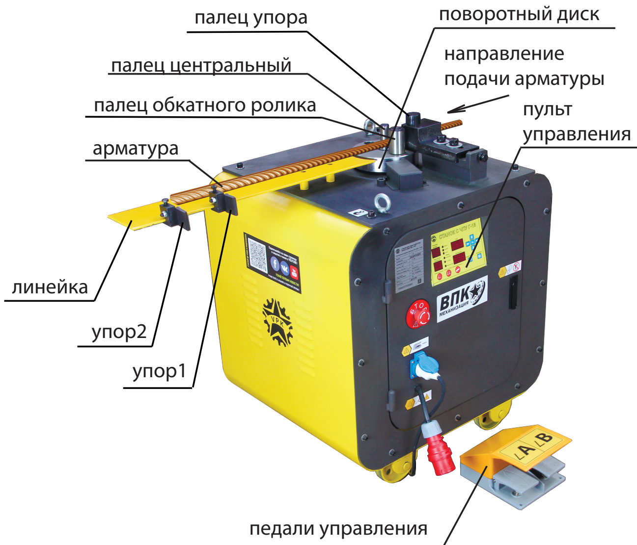
Рис.1 Конструкция станка
