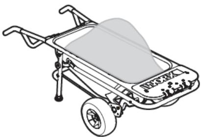
4.2 Максимальная нагрузка на откидную платформу составляет 300 фунтов (136 кг)
