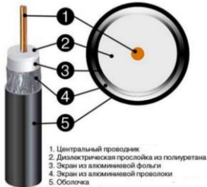
**Важно, чтобы центральная жила не соединялась ни с одним из проводов оплётки – это может привести к короткому замыканию и отсутствию видеосигнала.**
