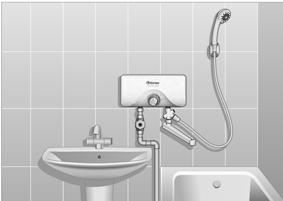
**Рис. 2.** Возможные варианты установки ПЭВН
