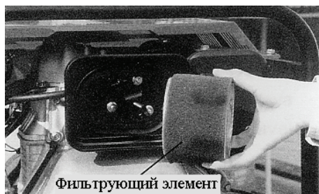
Рис.11. Обслуживание воздушного фильтра
