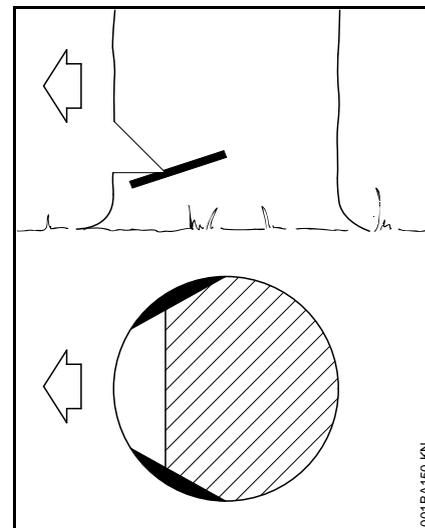
У длиноволокнистой древесины заболонные резы предотвращают разрыв заболони при падении ствола – запиливание производить с обеих сторон ствола на уровне основания подпила на глубину приблизительно 1/10 диаметра ствола – у толстых стволов максимально на ширину направляющей шины.
