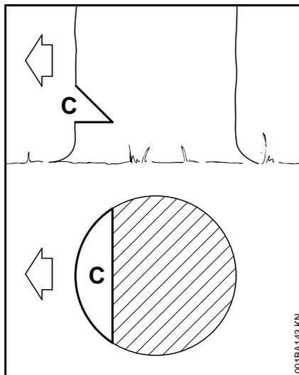
Подпил (С) определяет направление валки дерева.
