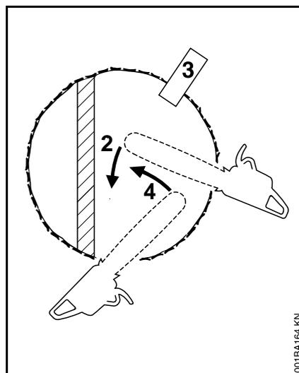
2. При переходе к следующему резу направляющая шина должна находиться полностью в резе, во избежание неровного основного пропила – после этого снова установить зубчатый упор и т.д.
