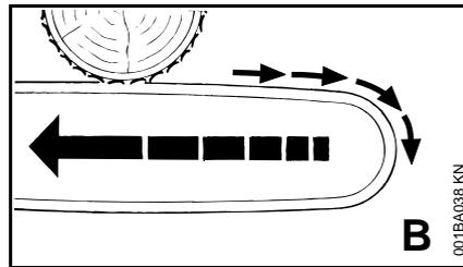
Если при пилении верхней стороной направляющей шины – обратный пропил – цепь пилы защемляется или наталкивается на твердый предмет в древесине, то пила может быть отброшена в сторону пользователя – **во избежание этого:**
