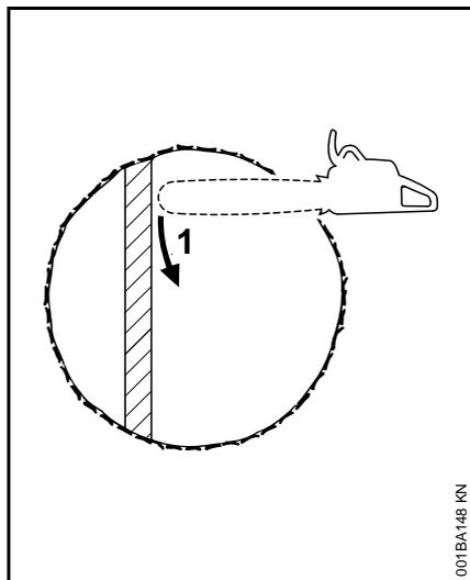
Подтянутый веерный пропил (многосекторный рез) производится в том случае, если диаметр ствола превышает длину реза мотопилы.
