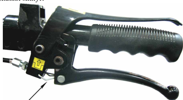
Скоба, блокирующая рычаги сцепления и пускового выключателя
